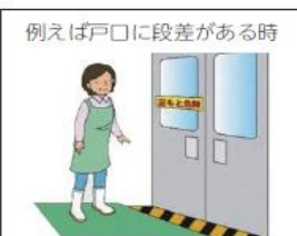
例えば戸口に段差がある時 解消できない危険箇所に 標識等で注意喚起
